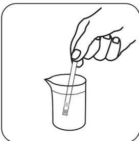
Sumerja la tira reactiva en la solución a analizar de forma que todas las almohadillas queden completamente sumergidas. (1 segundo)
