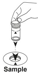
Die Probenküvette in den Messschacht stellen.
