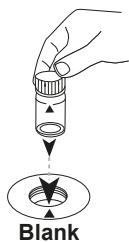
Placez la **cuvette du blanc** dans la chambre de mesure. Attention à la positionner correctement.
