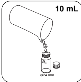
用 10 mL 准备好的样本填充 24 mm 比色杯。
