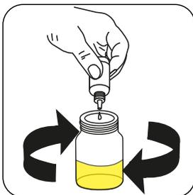
Ajoutez au goutte à goutte **Alkalinity LR Titrant TA3** ou **Alkalinity HR Titrant PA2/TA2** au échantillon jusqu'à obtention d'une coloration **violet** à **jaune pâle**.
