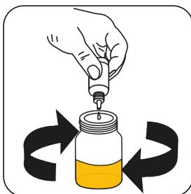
Ajoutez au goutte à goutte **Alkalinity LR Titrant TA3** ou **Alkalinity HR Titrant PA2/TA2** au échantillon jusqu'à obtention d'une coloration **bleu à orange/jaune** .
