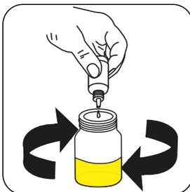
Ajoutez au goutte à goutte **Alkalinity LR Titrant TA3** ou **Alkalinity HR Titrant PA2/TA2** au échantillon jusqu'à obtention d'une coloration **violet** à **jaune**.
