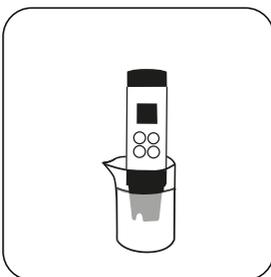
Tenir le testeur sans le capuchon de protection dans l'échantillon d'eau à mesurer de manière à ce que l'électrode et la sonde de température soient immergées dans l'échantillon d'eau jusqu'à la hauteur du joint d'étanchéité.
