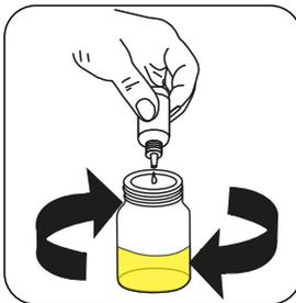
Añadir gota a gota **Chlorine LR Titrant CL4** o **Chlorine HR Titrant CL5** en la muestra hasta que adquiera una coloración de **naranja/marrón** a **amarillo pálido**.
