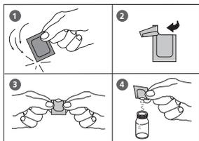
1. Abrir uma cuvete de reagente fechada com tampa de enroscar branca e encher com **0,1 ml de água desmineralizada** (cuvete zero).
