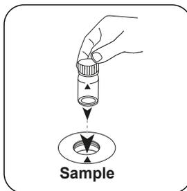
Poner la **cuveleta de muestra** en el compartimiento de medición. ¡Debe tenerse en cuenta el posicionamiento!
