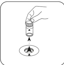
Extraer la cuveleta del compartimiento de medición.
