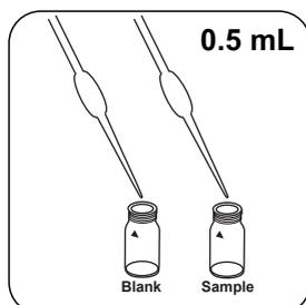
Immettere **0.5 mL di soluzione VARIO Sulfide 2** in ogni cuvetta.
