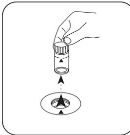
Prelevare la **cuvetta** dal vano di misurazione.
