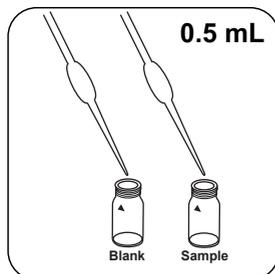
Immettere **0.5 mL di soluzione VARIO Sulfide 1** in ogni cuvetta.
