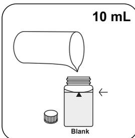
Immettere **10 mL di acqua demineralizzata** nella cuvetta zero.
