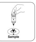
Colocar a **célula de amostra** no compartimento de medição. Observar o posicionamento.
