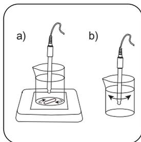
Plongez l'électrode pH, y compris la sonde de température, dans la solution de calibration. Veillez à ce qu'il y ait suffisamment de flux :
