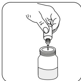
Adicionar **5 gotas** de **Chelant Free Buffer FC1** por **10 mL** de amostra.
