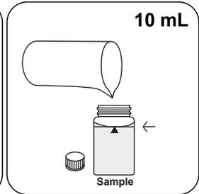
**10 mL Probe** in die Probenküvette geben.
