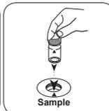
Die **Probenküvette** in den Messschacht stellen. Positionierung beachten.
