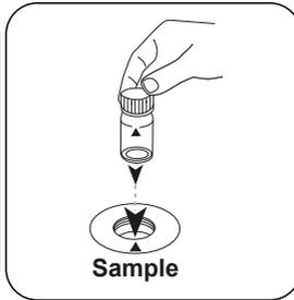
Die **Probenküvette** in den Messschacht stellen.
