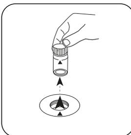
Prelevare la cuvetta dal vano di misurazione.
