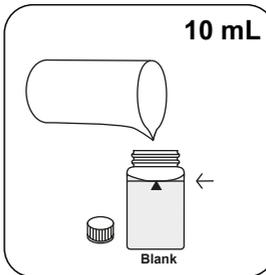
Immettere **10 mL di acqua demineralizzata** nella cuvetta zero.
