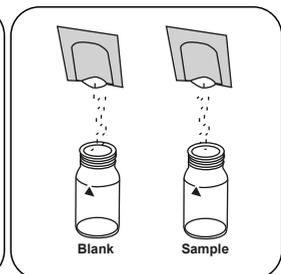
Immettere **una bustina di polvere Vario Ammonium Cyanurate F10** in ogni cuvetta.
