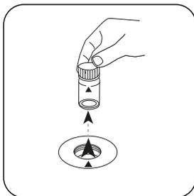
Prelevare la cuvetta dal vano di misurazione.
