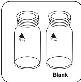
Preparare due cuvette pulite da 24 mm. Contrassegnare una cuvetta come cuvetta zero.
