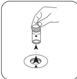
Prelevare la cuvetta dal vano di misurazione.
