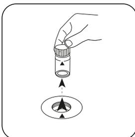
Prelevare la cuvetta dal vano di misurazione.
