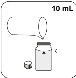
用 10 mL 样本填充 24 mm 比色杯。 密封比色杯。
