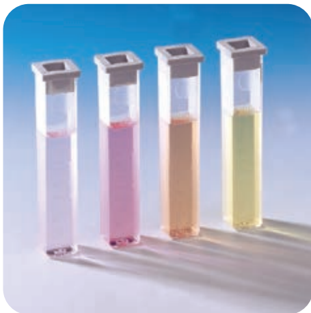
Cubetas de plástico opacas en dos lados, 10 ml de volumen, 13,5 mm de profundidad de capa, con tapas
