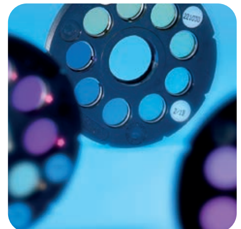
Discos de color con estándares de vidrios originales y estables a la luz
