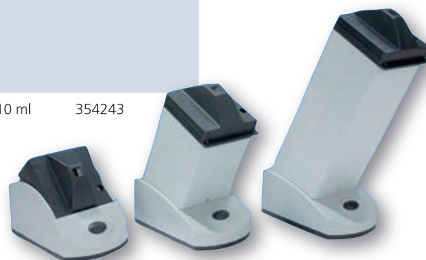
Nessleriser con lámpara de luz diurna
