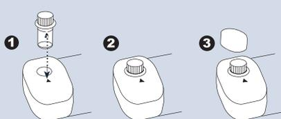
**Tenez** les cuves par le bouchon afin d'éviter les salissures et les empreintes digitales sur le verre. Enlevez les impuretés avec un chiffon non pelucheux. Indexez la cuve pour une précision de mesure maximale.
