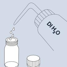
**Après** chaque mesure, rincez soigneusement les cuves avec de l'eau désionisée. Nettoyez avec des produits de nettoyage de laboratoire et rincez avec de l'eau désionisée. Nettoyez les fortes impuretés avec du HCl 1:1 et rincez plusieurs fois.
