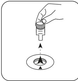
Prelevare la **cuvetta** dal vano di misurazione.
