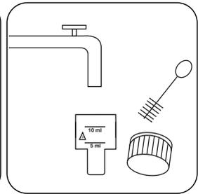
Pulire a fondo la cuvette e il coperchio della cuvette.
