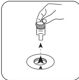
Prelevare la **cuvetta** dal vano di misurazione.
