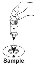
Placez la **cuvette réservée à l'échantillon** dans la chambre de mesure.
