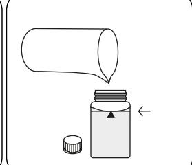
Remplissez la cuvette jusqu'au **repère de 10 mL** en y versant l'échantillon.
