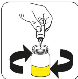
Adicionar **10 gotas Chloride Indicador BC1/CC 1 (Cromato de Potássio)** até obter uma cor **amarelo**.
