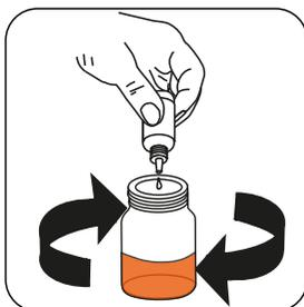
Adicionar **Chloride LR Titrate CC2** ou **Chloride HR Titrate BC2** gota a gota da amostra até aparecer uma coloração **amarelo a laranja/castanho**.
