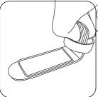
Toma de muestras en superficies: Se debería tomar la muestra permitiendo el contacto directo entre la superficie de agar y el material del ensayo. La pala es flexible y se puede doblar en el extremo superior para permitir que ambas superficies entren en contacto directo.
