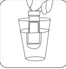
Toma de muestras de líquidos: La muestra se toma sumergiendo ambos lados de la paleta en el líquido a analizar.
