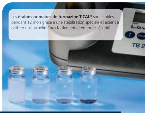
Les étalons primaires de formazine T-CAL® sont stables pendant 12 mois grâce à une stabilisation spéciale et aident à calibrer nos turbidimètres facilement et en toute sécurité.
