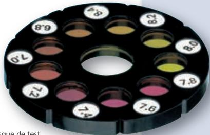
Disque de test avec étalons de verre à couleur stable
