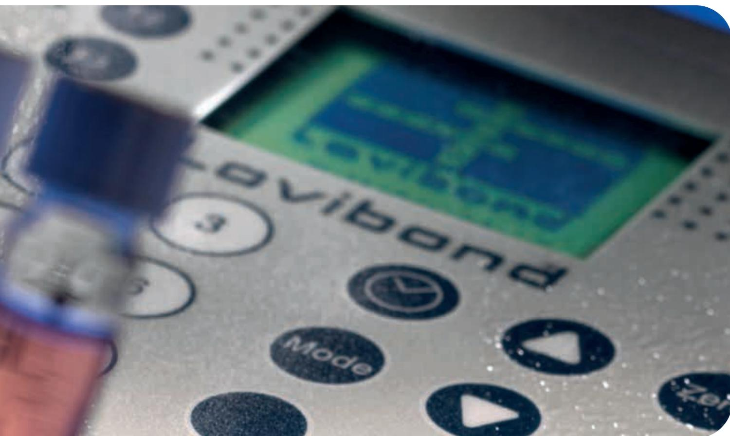
Le MultiDirect est un photomètre moderne piloté par microprocesseur avec un clavier ergonomique et un écran graphique grand format. Il dispose d'une large sélection de méthodes préprogrammées basée sur la gamme éprouvée Lovibond® de réactifs en pastilles, liquides, poudre (sachets de poudre VARIO) et tubes prêts à l'emploi.
