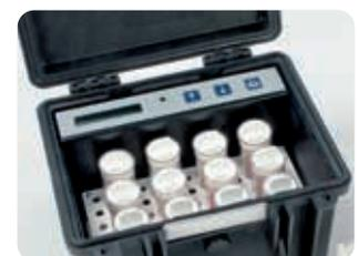
L'incubateur **DI10** permet une incubation fiable des dipslides bactériens sur place, en laboratoire ou même en déplacement dans une voiture.
