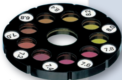
Disque de test avec étalons de verre à couleur stable
