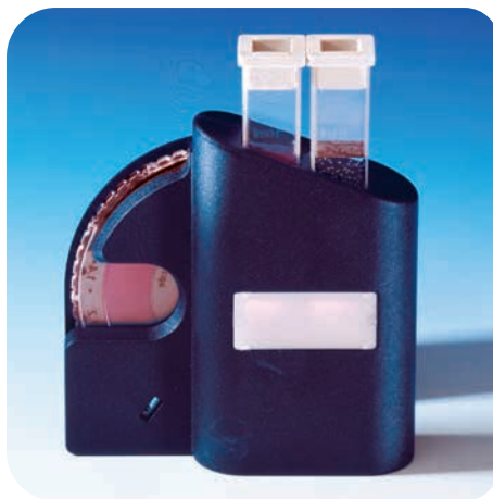
Vue de derrière du comparateur CHECKIT® avec disque, plaque de diffusion et cuvettes
