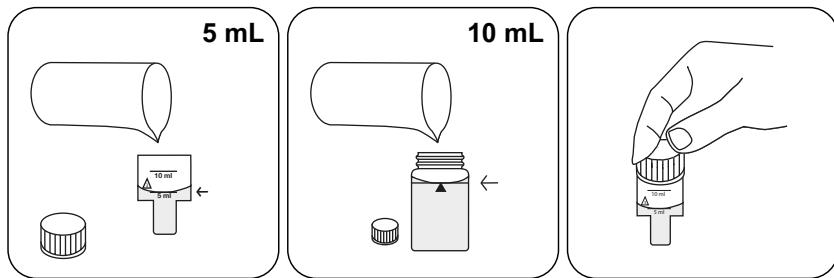
Encher a célula de 10 mm com **5 mL de amostra**.
