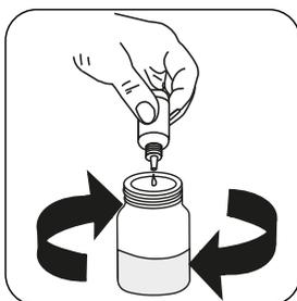
Ajouter **Alkalinity LR Titrant TA3** ou **Alkalinity HR Titrant PA2/TA2** goutte à goutte à l'échantillon jusqu'à ce que la décoloration passe de **rose** à **incolore**.
