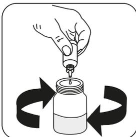
Ajouter **Solution de titrage du glutaraldéhyde GL2** goutte à goutte à l'échantillon jusqu'à ce que la décoloration passe de **rose** à **incolor**.
